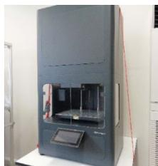
造形、脱脂、焼結の3工程を経て様々な材質の金属パーツを作成することのできる3Dプリンタ(積層造形装置)。
