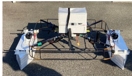
図1 配送用ドローン 水面移動用フロートを搭載
