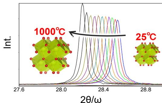
XRDを用いた酸化セリウムの熱膨張によるピークシフト
