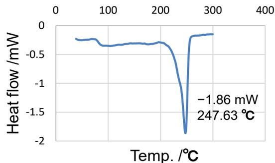
DSCを用いた昇温動作におけるポリエチレンテレフタラートのSecond cycle data
