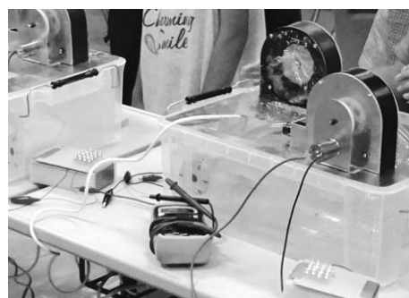
ペルトン水車キットの発電実験
