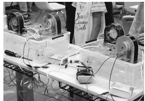
ペルトン水車キットの発電実験
