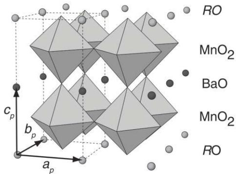
図1 Aサイト秩序型 $\text{RBaMn}_2\text{O}_6$ の結晶構造
