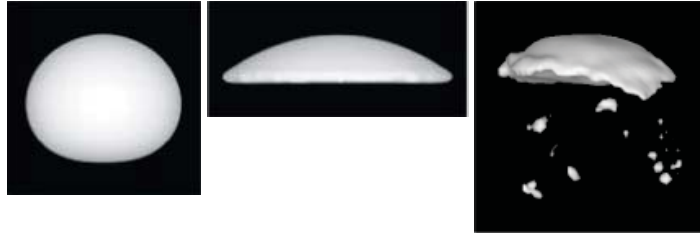
図1 粘性流体中を上昇する気泡
