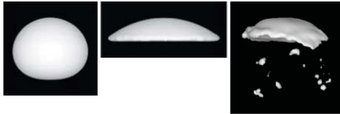
図1 粘性流体中を上昇する気泡
