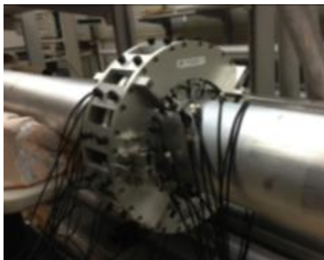
FIG. 2 配管検査用圧電式ガイド波センサー (世界標準方式2種類を国内で唯一保持している)
