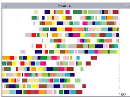
開発したguided ejection searchと呼ばれる手法を用いて発見したジョブショップスケジューリング問題ベンチマークの既知最良解の例
