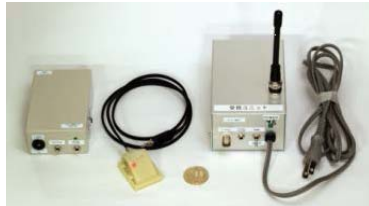
図1. 血流速度測定装置の試作機と測定された典型的な左総頸動脈血流速度波形
