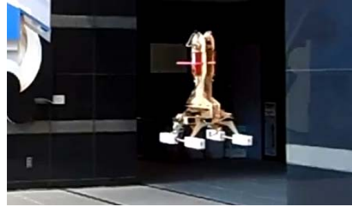
推力偏向技術を用いた倒立型飛行体
