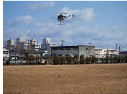
無人ヘリによる吊荷の揺れ止め制御
