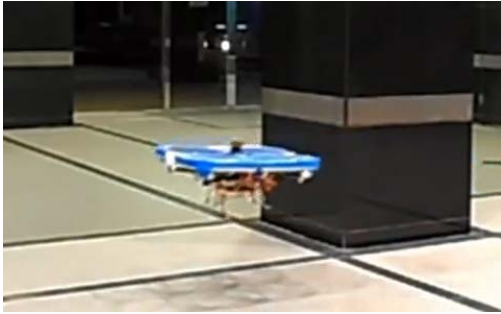
レーザーレンジファインダを用いたドローンの障害物回避
