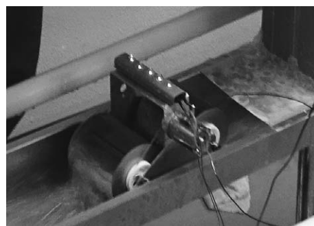
下掛け水車キットの発電実験
