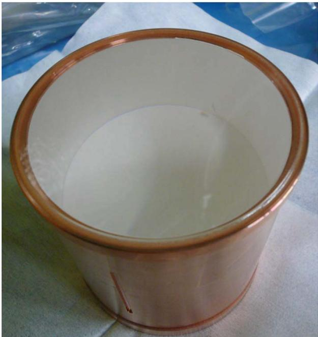
左図：世界最高純度を達成したタリウム添加ヨウ化ナトリウム検出器 PICO-LON
