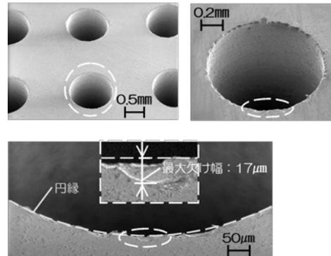
図3 加工穴の様子(工具抜け側)
