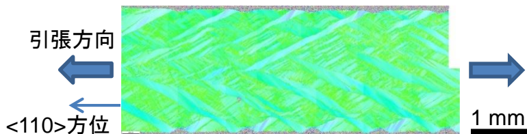
図2 銅単結晶平行部側面に溝加工を施し, 引張変形(25%) (SEM/EBSDにより結晶方位をカラー表示)
