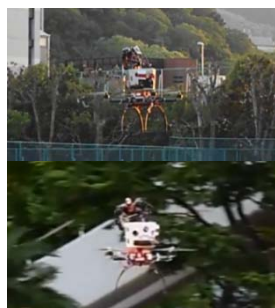
ヒューマノイドロボットによる マルチコプタの重心移動操縦
