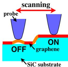
ポストシリコンのナノ材料として期待されているグラフェンの研究を行っている。SiC基板上に単結晶グラフェンをエピタキシャル成長させる技術を既に確立している。高速赤外線アニール装置を用いて10mm角のグラフェン試料を作製可能である。表面ステップ構造を制御したSiC表面に高均一にグラフェンを形成できる。
