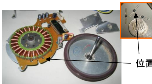
(b) 家庭に用いられる交流電動機(ブラシレスDCモータ)
