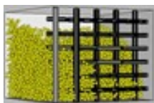
図-3 小型模擬型枠内の流動シミュレーションの一例
