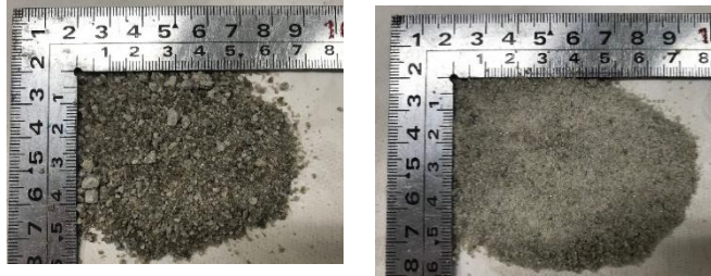
図1 高炉スラグ細骨材5mm(左)と1.2mm(右)
