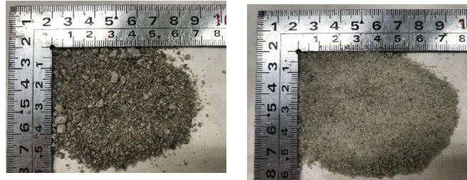
図1 高炉スラグ細骨材5mm(左)と1.2mm(右)
