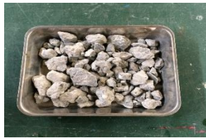
図2. 実験に使用した低度処置再生骨材
