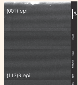
(b) エピタキシャルウエハの直接接合で作製した化合物半導体多層薄膜の断面 SEM 像図
