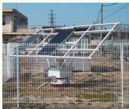
生物資源産業学部演習林内に設置した二軸太陽追尾装置の整備状況
