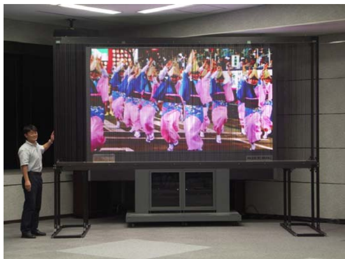
図1 大画面LEDを用いた眼鏡無し3Dディスプレイ.
