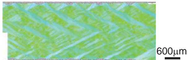
図2 引張変形した銅単結晶に形成した微細組織のSEM/EBSD法による解析例(結晶方位の違いをカラー表示)
