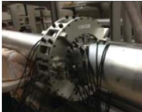
FIG. 2 配管検査用圧電式ガイド波センサー (世界標準方式2種類を国内で唯一保持している)
