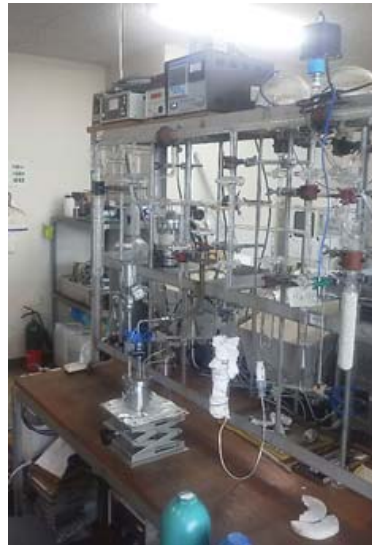
Fig. 1 水蒸気の吸脱着速度を自動測定可能な定容型吸着量測定装置..
