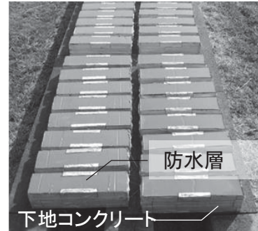
屋外暴露試験状況
