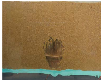
写真2 発生した空洞とフィーダーセンサ(正面)
