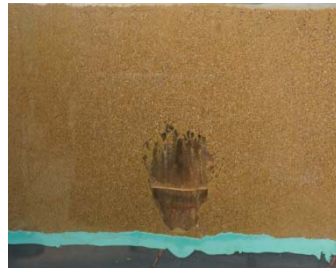
写真2 発生した空洞とフィーダーセンサ(正面)
